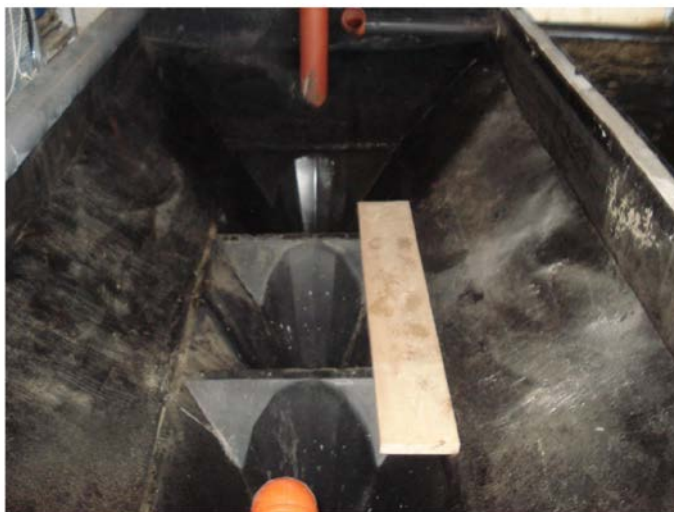
Рис. 12. Конусы для осаждения воды из механического фильтра
