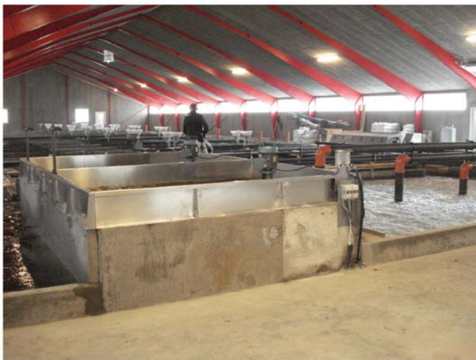
Рис. 3. Блок выращивания с блоком аэрации и инжекторной платформой на переднем плане
