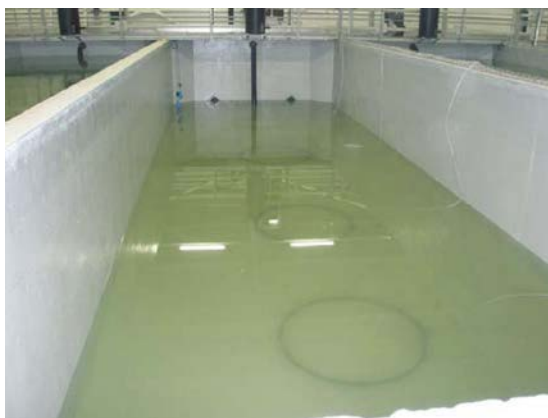
Рис. 20. Размеры бассейна (в чистоте по воде): 3,4 м – ширина, 10,1 м – длина, толщина слоя воды – 1,5 м
