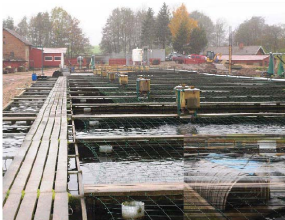
Рис. 3.6. Образцовое форелевое хозяйство Bregnholm Mølle (тип 1) с микроситами, вставленными в правом углу
