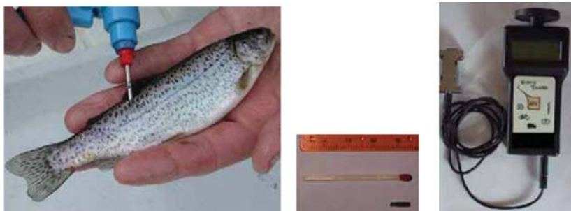
Рис. 3.1. Введение PIT-метки в тело рыбы (слева); PIT-метка в правом нижнем углу (в центре) и сканер (справа)
