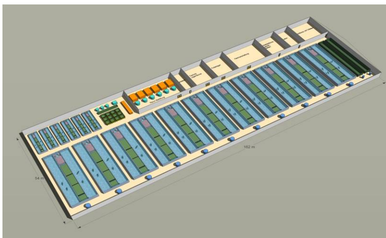
Рис. 15. Схема УЗВ с бетонными прямоугольными бассейнами (вариант 2)
