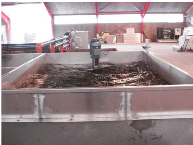
Рис. 4. Одна из двух инжекторных платформ для добавления жидкого кислорода в воду
