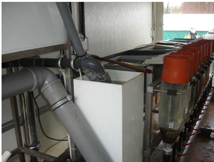
Рис. 41. Передвижной инкубационный мини-модуль на базе автомобильного прицепа (вид внутри) (Институт рыбного хозяйства, Ольштын, Польша)
