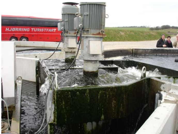
Рис. 6. Два насоса для платформ с инжекторами
